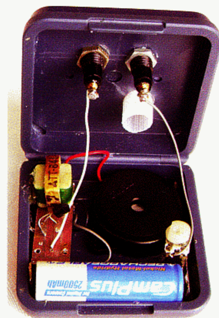
Obr. 3. Zkoušečka s nf oscilátorem obsahujícím jeden Si tranzistor a výstupní transformátor
